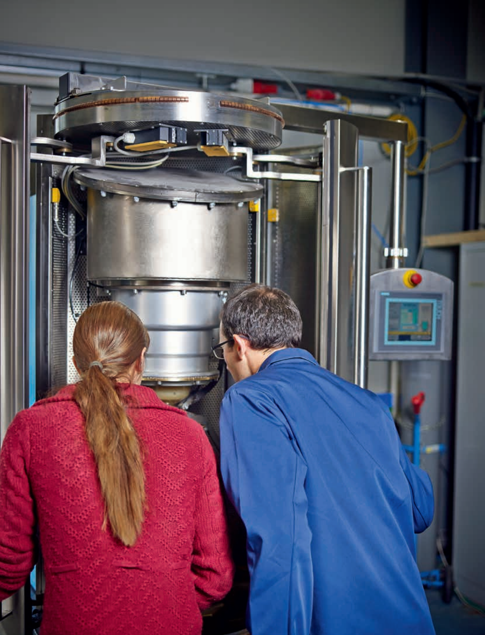
Durch Hochspannungsentladungen zerlegt eine Anlage der Firma Selfrag AG Kunststoffteile, um daraus Fasern für die Forschungsversuche der FHNW zu gewinnen.
