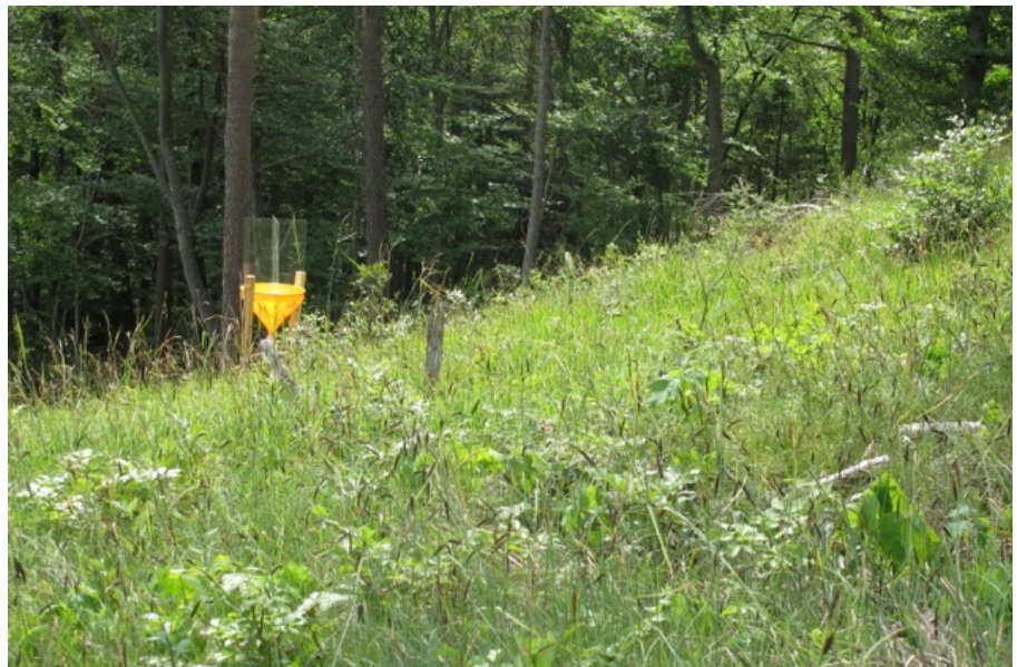
Abb. 3: Kombifalle für den Nachweis von Totholzkäfern auf dem Binzenberg, Bretzwil. Die gelbe Farbe des Trichters lockt die Käfer an, die mit einer Plexiglasscheibe kollidieren, in den Trichter geraten und dann in einen Fangbehälter unter dem Trichter fallen.
