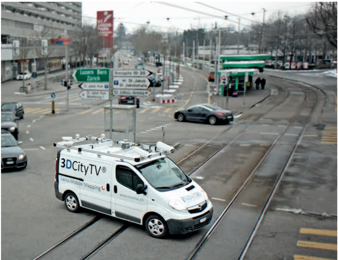
Rollende Vermessung der Strasseninfrastruktur mit der 3DCityTV-Technologie.
