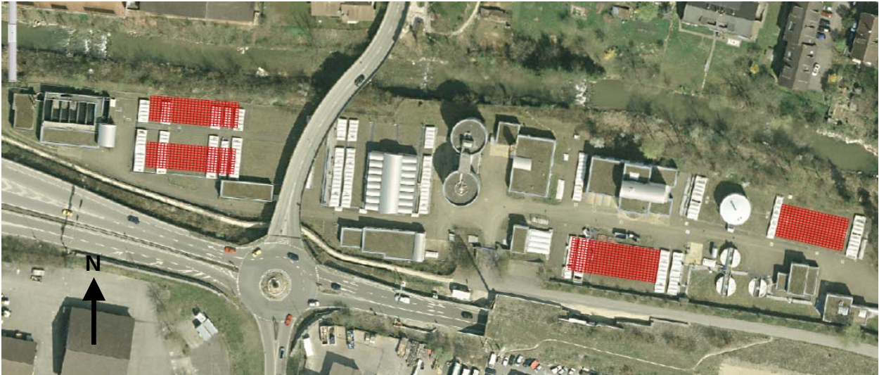
Abbildung 6: Belegung der Vorklär-, Biologie- und Mischwasserbecken der ARA Ergolz 1 mit Carport-Systemen.
