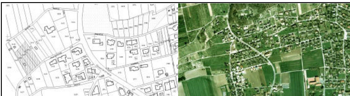
Abb. 1: Beispiel Vektordaten: Grundlagenkarte Abb. 2: Beispiel Rasterdaten: Orthophoto
